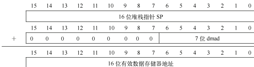
图 4-5 SP 作为基地址的直接寻址方式
