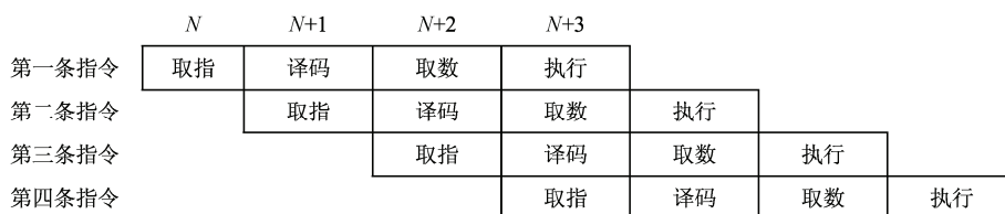
图 1-2 流水线技术示意图
