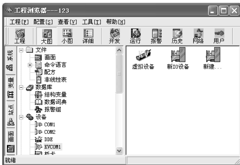
图 8-27 定义完成的 DTU 设备和实际设备
