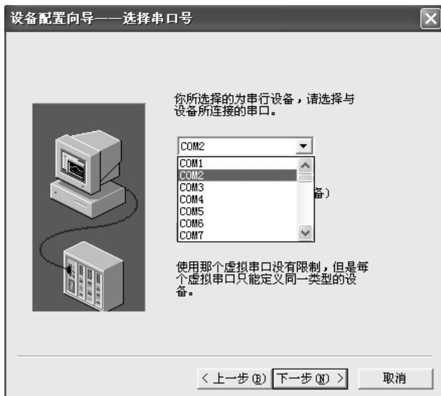
图 5-53 选择计算机这边的串行通信口
