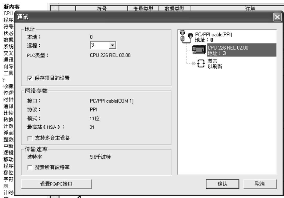
图 4-36 通信后已搜到 PLC 的地址
