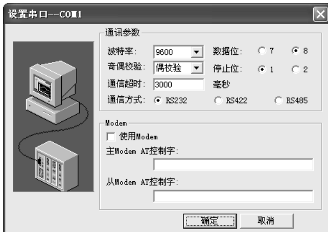
图 5-48 定通信速率及数据长度等
