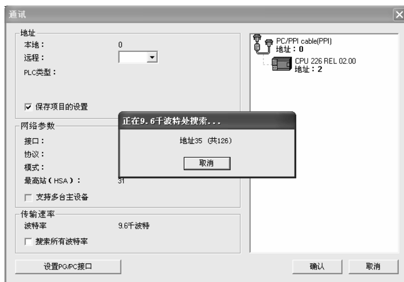
图 6-26 计算机正在与 PLC 通信
