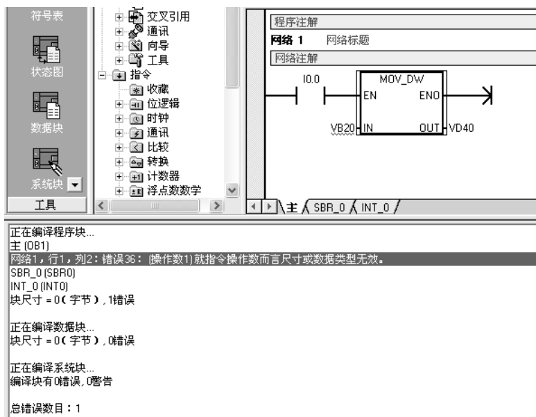
图 6-41 在信息输出窗口显示编译结果
