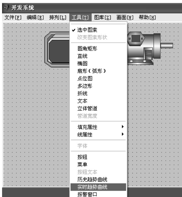
图 5-67 制作速度变化曲线
