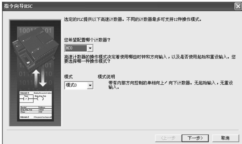
图 6-57 “向导”编辑高速计数器程序的第一个对话框
