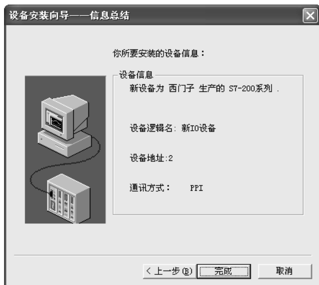
图 5-55 通信参数设置完成
