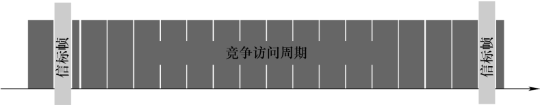
图 5-4 通用的超帧结构
