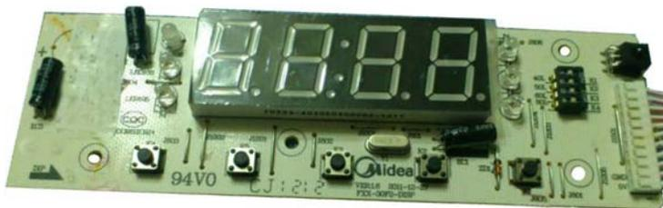
图 5-51 美的 F60-30G4 型电热水器显示板
