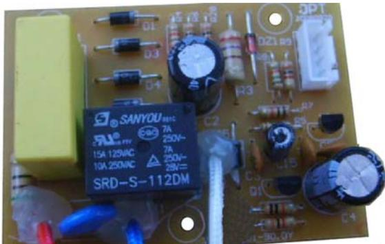
图 5-40 苏泊尔 CYSB40YC1-90 型电压力煲电源板
