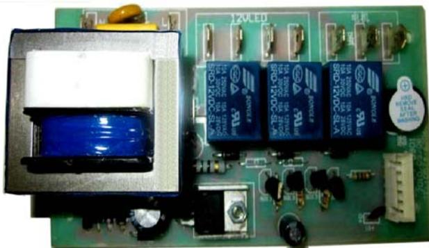
图 5-134 普田 CXW-160-6901A 型吸油烟机电源板
