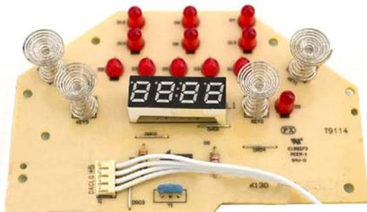
图 5-1 九阳 DJ11B-D19D 型豆浆机显示板
