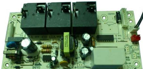
图 5-52 美的 F80-21B1 型电热水器电脑板
