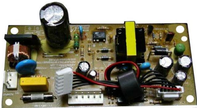
图 5-146 飞利浦 AC4090 型空气净化器电路板
