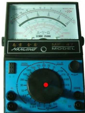
图 1-1 MF47 型指针式万用表
