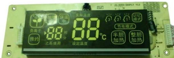
图 5-53 美的 F80-30D3 型电热水器显示板
