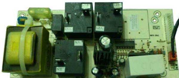
图 5-54 美的 F80-30D3 型电热水器电源板
