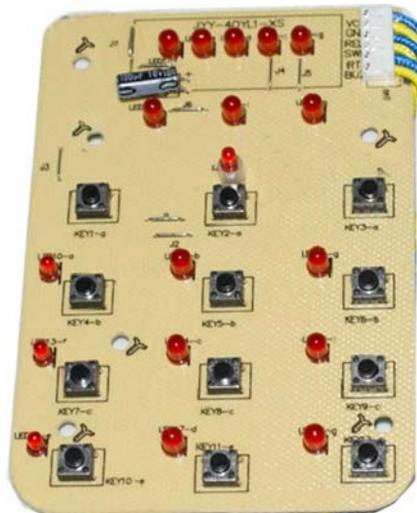
图 5-2 九阳 JYY-40YL1 型电压力煲显示板
