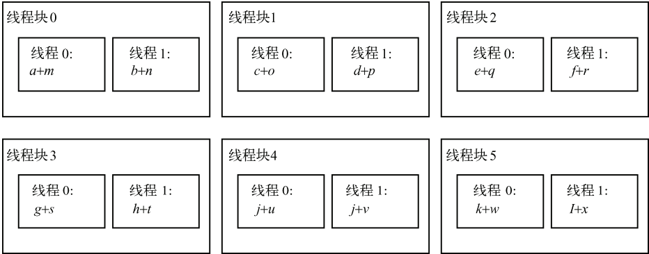
图 4.4 每个线程块有两个线程的逻辑分组
