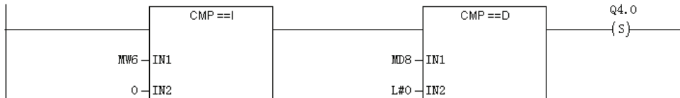
程序段 3：如果是 I0.1 产生的中断，将 Q4.0 复位
