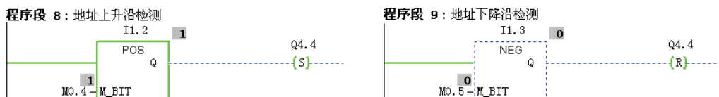
图 3-5 单个位地址位信号的下降沿检测指令
