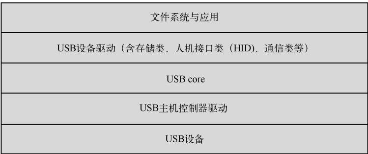
图 14-3 Linux 下的 USB 驱动程序体系
