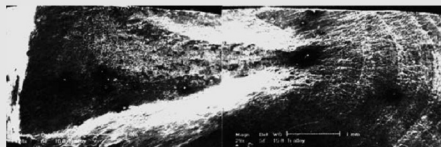
图 6.4 左臂疲劳断口低倍形貌
