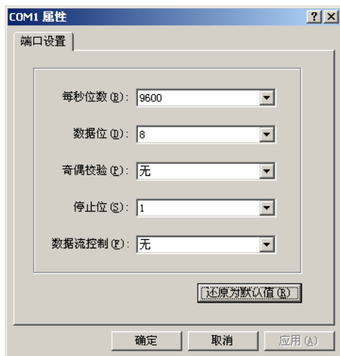
图 10-8 超级终端中串口通信参数的设置
