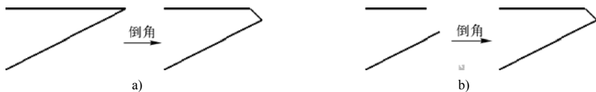
图 4-63 倒角过渡的两种典型情形
