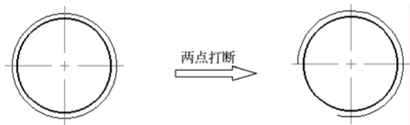
图 4-81 两点打断的典型示例
